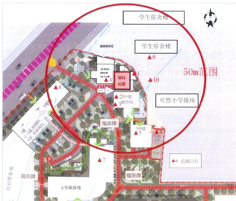
图 13 医用电子直线加速器应用场所周围环境监测点位布置图（10MeV，机头朝上）
