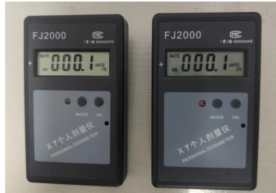
图 3-25 个人剂量报警仪
