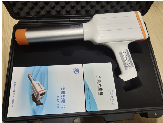
图 3-24 便携式辐射检测仪
