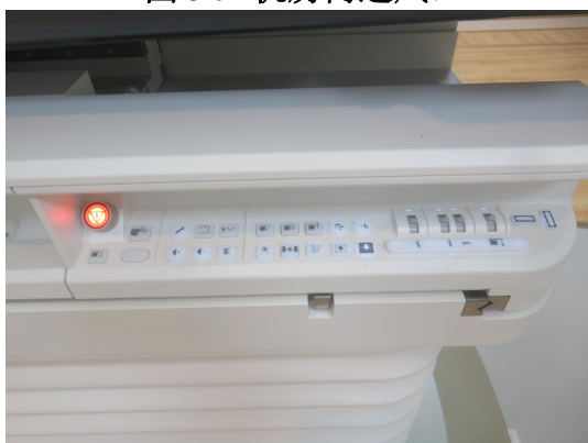
图 3-11 治疗床上紧急停机按钮
