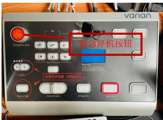
图 3-15 控制室控制面板
