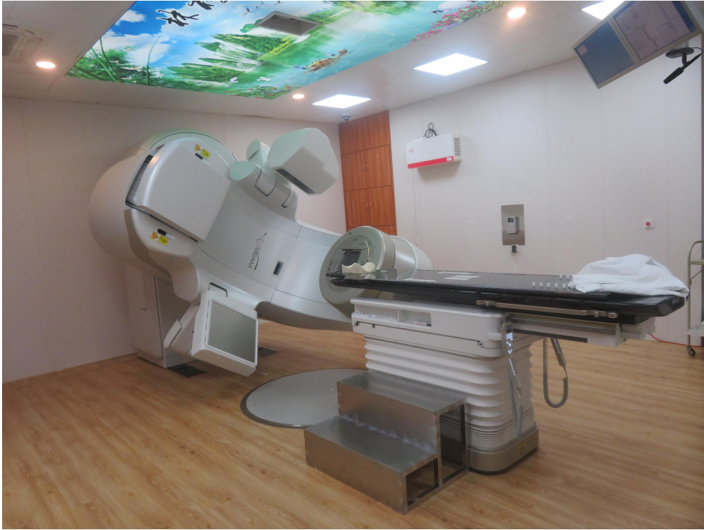
图 2-3 VitalBeam 型医用电子直线加速器
